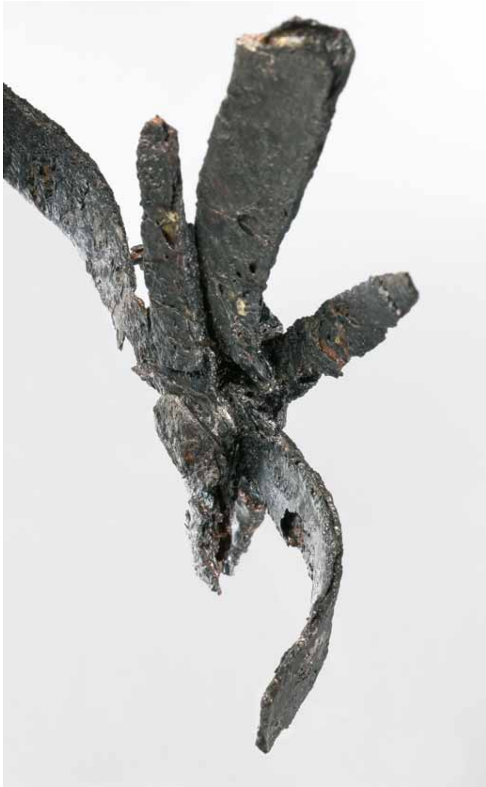
Abb. 4 Xanten, Colonia Ulpia Traiana. Fenstergitter Kat. Nr. 6, Typ IIB3 in seitlicher Ansicht mit den insgesamt vier Lagen am Nietpunkt.
